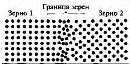
Рис. 2.9. Размещение атомов внутри зерна и на границе между зёрнами
