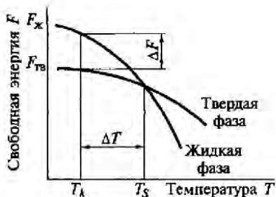
Рис. 2.11. Изменение свободной энергии ( F ) жидкого ( F_{ж} ) и твердого ( F_{тв} ) металла в зависимости от температуры:
