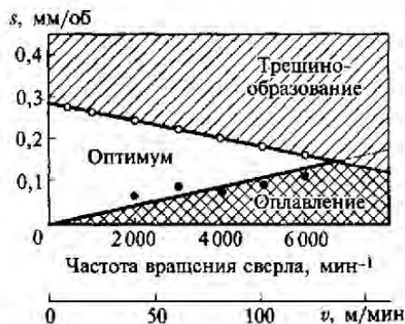
Рис. 9.4. Влияние режимов сверления на качество поверхности полиметилакрилата
