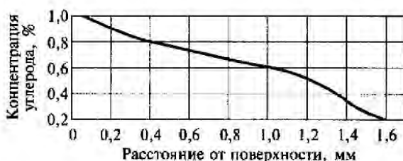
Рис. 5.23. Изменение концентрации углерода в цементованном слое
