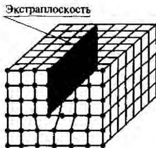
Рис. 2.6. Линейный дефект кристаллической решетки — краевая дислокация
