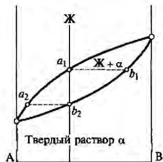
Рис. 2.24. Диаграмма состояния твердого раствора с неограниченной растворимостью компонентов
