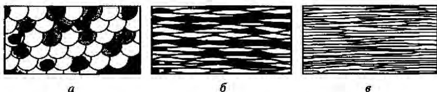
Рис. 2.30. Изменение структуры при пластической деформации металла: a — структура металла до деформации; б — структура металла после первой операции деформации; в — структура металла после окончательной деформации
