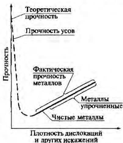
Рис. 2.8. Зависимость прочности металла от искажений кристаллической решетки
